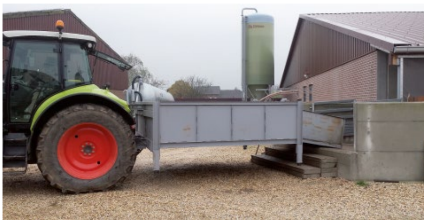
Mobile Waage im Eigenbau.
