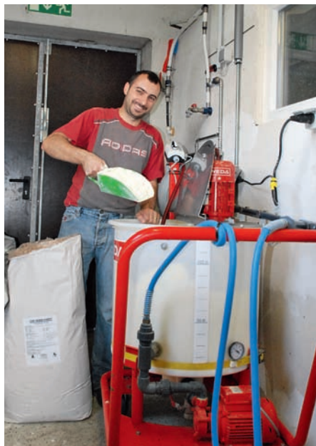
Das Milchpulver wird direkt in das 45 bis 50 °C heiße Wasser im Mischbehälter eingerührt.
