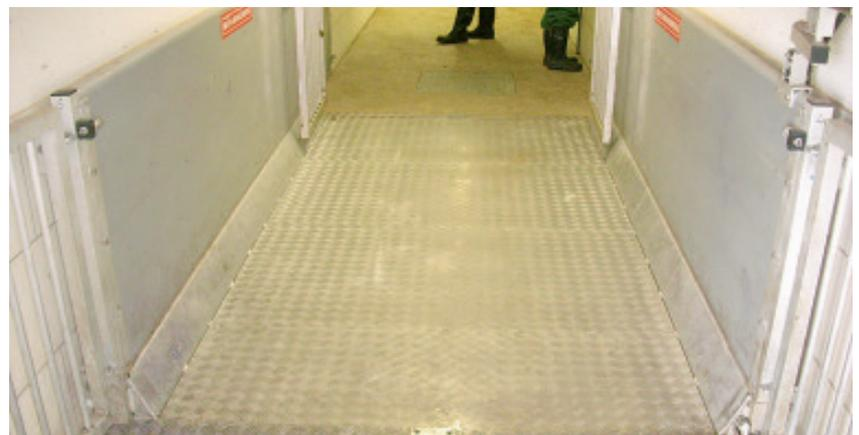
Mit einer Höhe von nur etwa 4 cm steht die Waage im Gang und braucht nicht in den Boden eingelassen zu werden. Durch das exakte Wiegen der Tiere wird die Varianz deutlich geringer, ohne dass ein Teil der Tiere aus dem Gewichtsoptimum rutscht.
