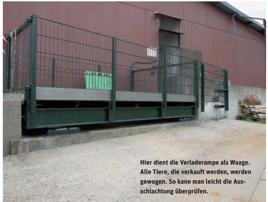
Hier dient die Verladerampe als Waage. Alle Tiere, die verkauft werden, werden gewogen. So kann man leicht die Ausschachtung überprüfen.
