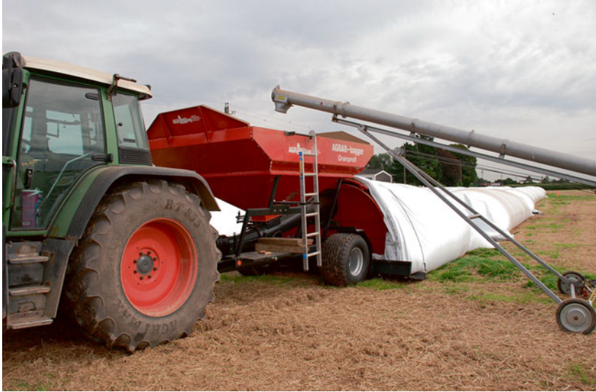
Das Getreide gelangt über eine Förderschnecke in das Befüllungsgerät und wird von dort in den Schlauch gedrückt. Die Befüllleistung liegt bei 300 t/h.
